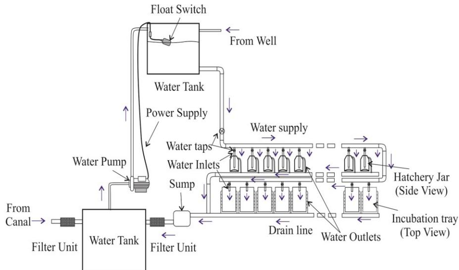
**Figure 2.** Line diagram of the mini hatchery unit
